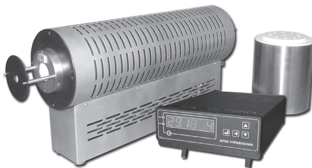
печь трубчатая ПТ с установленной диафрагмой
