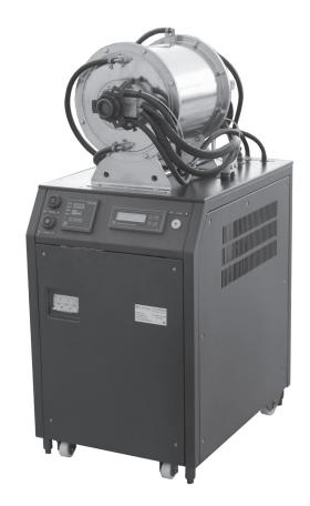
АЧТ может работать в двух режимах - автоматическом и ручном. При выборе автоматического режима работы пользователь задает требуемое значение температуры. При выборе ручного режима работы пользователь сам задает значение подаваемой мощности, влияющее на скорость нагрева и на конечное значение температуры.
