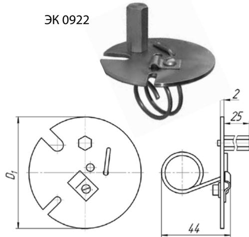
**ОГОЛОВОК ДЛЯ ТЕРМОМЕТРИЧЕСКИХ СКВАЖИН ООТ 0922, ОТС 0922**
