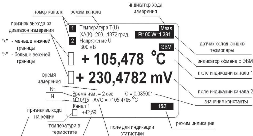
T < - прибор не прогрет; T = - прибор готов к работе; T > - прибор перегрет
