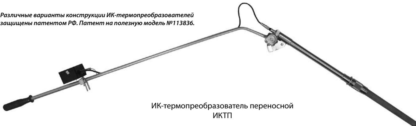
ИК-термопреобразователь переносной ИКТП
