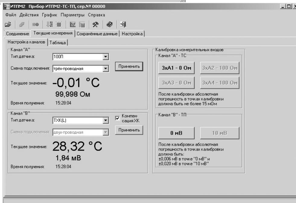
Рис.7 Вкладка «Текущие измерения»
