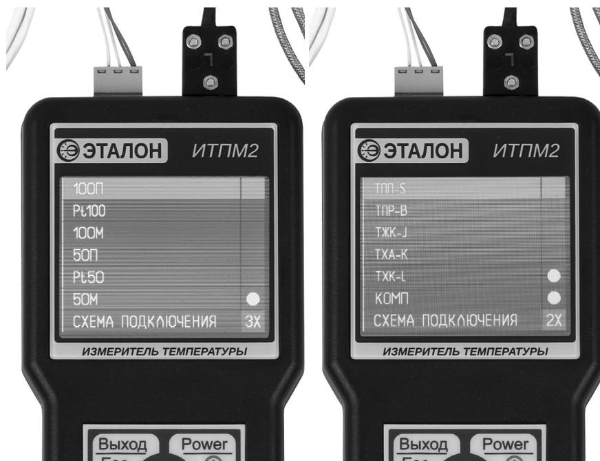
Рис.4 Выбор типа датчика на канал
