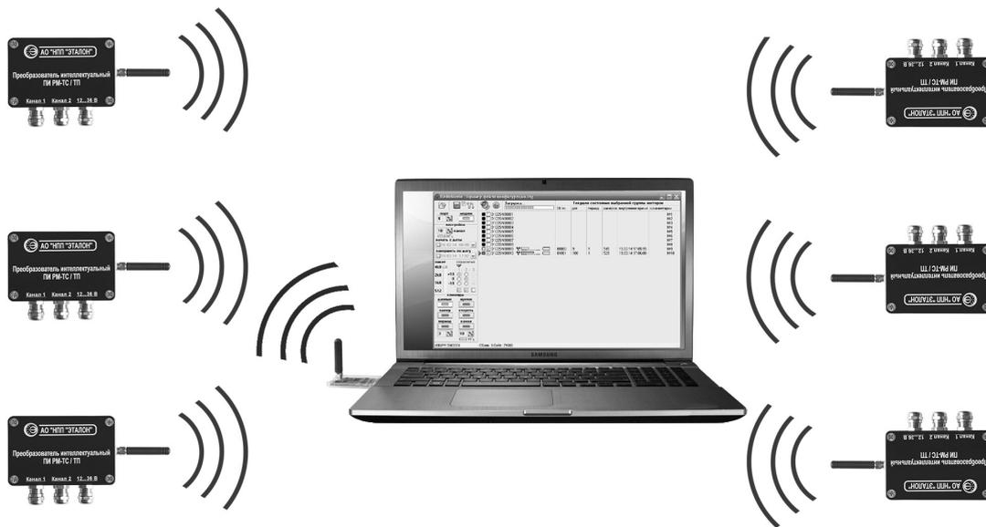
**Количество ПИ РМ в одной измерительной сети – до 50 шт., с различными типами датчиков для измерения различных физических величин.**
