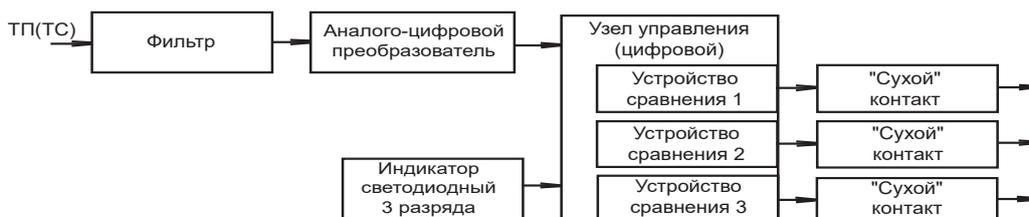
**Схема подключения РТ-10, предназначенных для работы с термопарными датчиками (кроме ТПР(В))**
