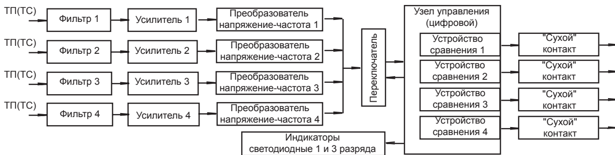
Структура регулятора температуры РТМ-4К
