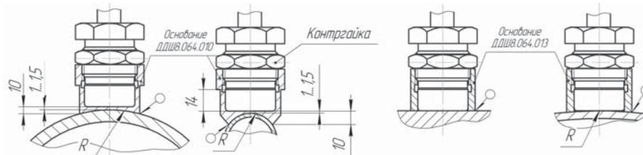
При установке ТСП 9508 на трубопровод основание ДДШ8.064.010 обработать под радиус R трубопровода. С помощью основания ДДШ8.064.013 устанавливается термопреобразователь на плоскость или на трубопровод радиусом R более 500 мм. Термопреобразователь завернуть до упора и затянуть контргайку.
