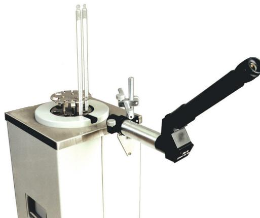
Термостат ТР-1М с установленными на нем кассетой для поверки стеклянных термометров и видоискателем
