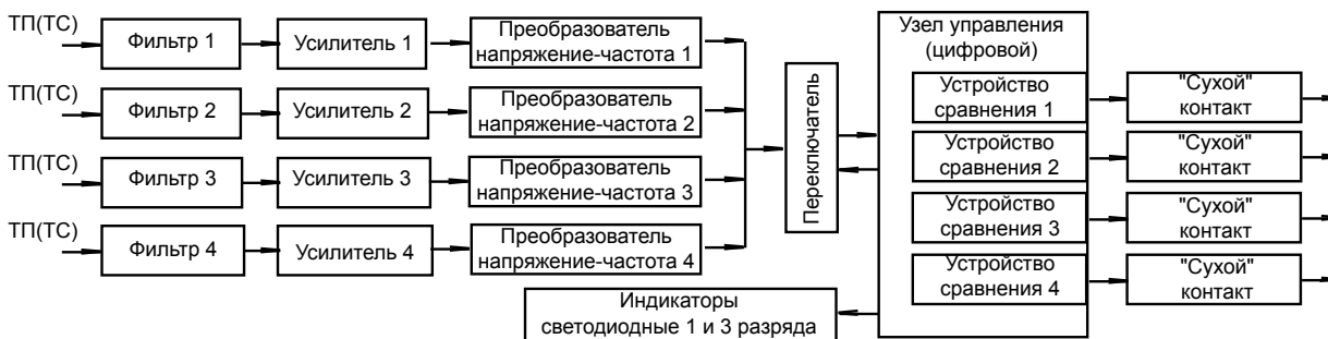
Структура регулятора температуры РТМ-4К
